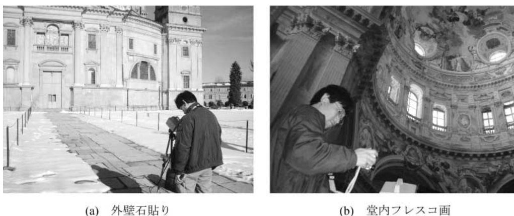
図2-17 赤外線サーモグラフィ法による浮き調査状況
