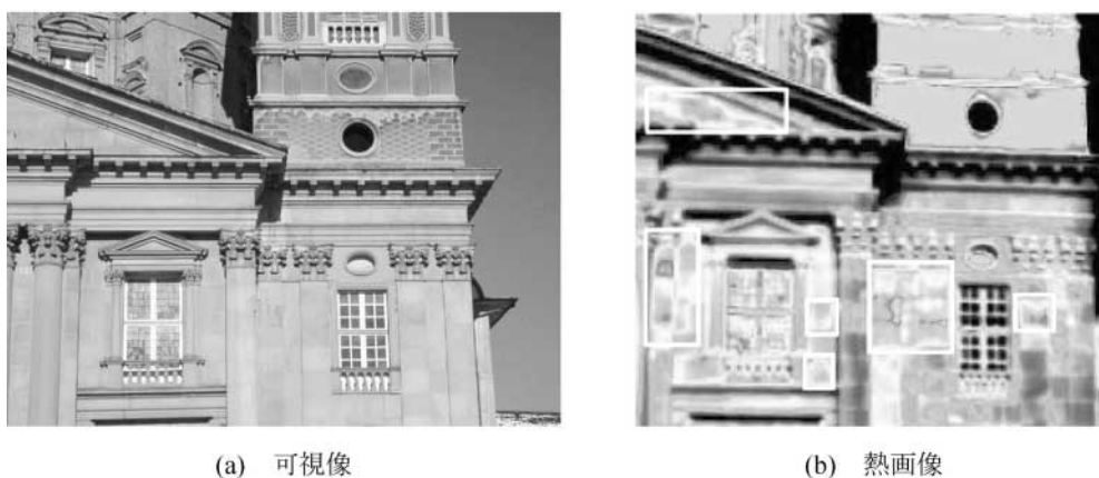
図2-18 赤外線サーモグラフィ法による外壁石貼りの浮き調査結果（南東面）
