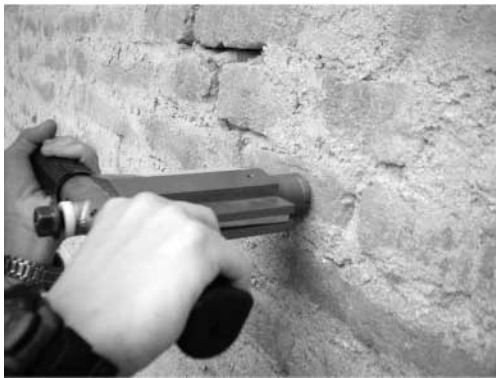
図2-30 ウィンザーピン貫入抵抗値の測定状況
