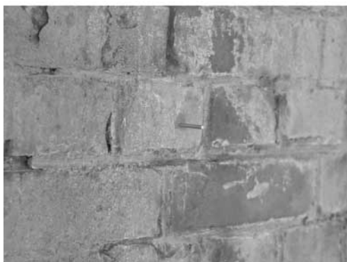
図3-24 ウィンザーピン貫入抵抗値測定状況
