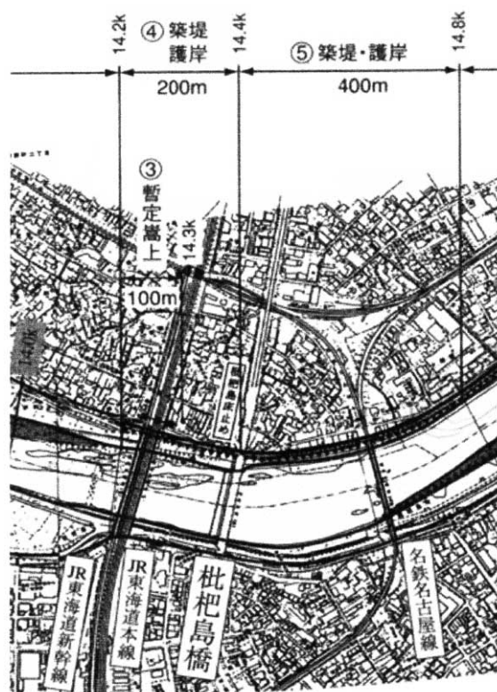
図-6 庄内川築堤護岸工事位置図
