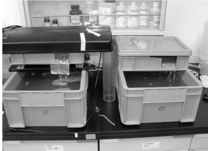
写真1 下水処理実験開始時の下水状況 (左) UV照射系 (右) UV非照射系
