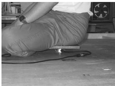
写真1 振動レベル計のピックアップ上に人が座った状態
