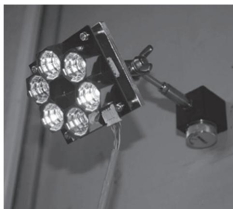
図7. 試作したLED照明ユニット
