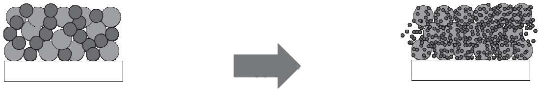
図1 新型電極のイメージ 電極触媒の微粒化による水蒸気改質反応の活性点数の増加
