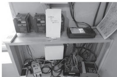
図6. 室内に設置されたデータロガー
