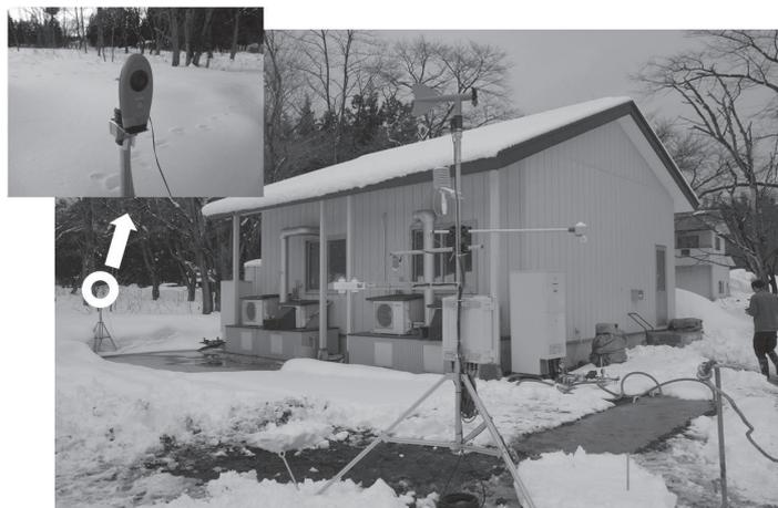
図7. 小規模融雪システム近傍に設置された自動気象観測装置とインターバルカメラ(白丸の位置)
