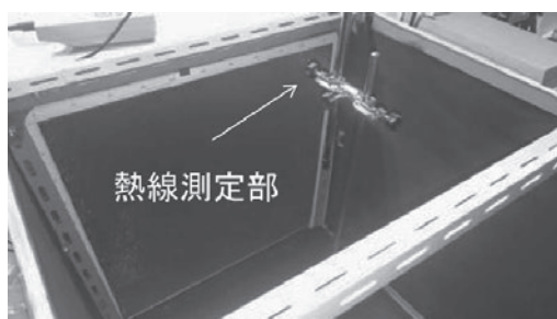
図1. 熱線風速計の設置(風洞出口のハニカム直後に設置している様子)
