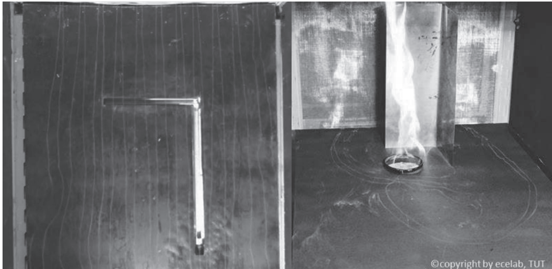
図12. 改善された風洞における流れ場(左:凍結流、右:火災旋風の模型実験における後流に存在する渦を明確に可視化した一例)
