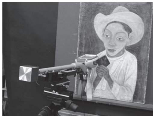
調査風景：携帯型蛍光X線装置
