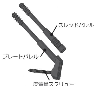
図5 インプラントDual SC Screwの形状モデル
