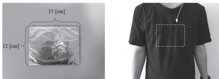
図2 着衣へのアルミ箔の装着.
