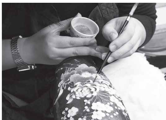
図3. 尾張七宝 ガラス釉薬入れ作業
