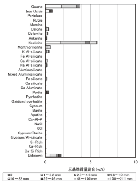
Included 鉱物粒子および Excluded 鉱物粒子の質量基準の累積分布
