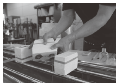
図15. 排泥鑄込みの様子
