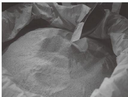
図9. 粉碎・原料化された再生材(セルベン), 神明リフラックス株式会社/岐阜県土岐市
