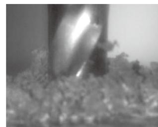
図1 穿孔加工で生じる微細粉塵型切りくず
