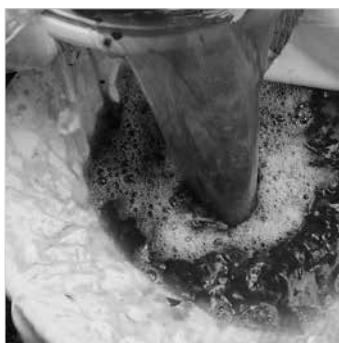
05. 藍の生葉(+茎)などを取り除くために濾し布で濾していく作業。
