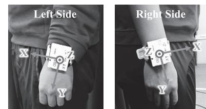
図2. センサの装着レイアウトと軸の設定
