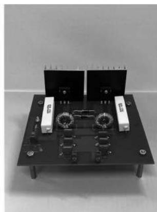
図2 作製した非接触充電基板
