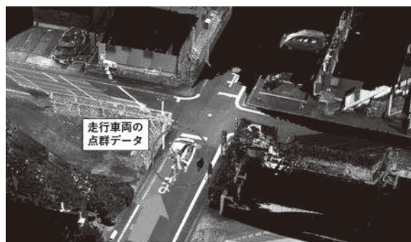
図11. 走行車両の点群データ(進入方向6)
