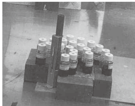
図1. ^{60}\text{Co} を用いたIOPs分散液の放射線照射実験の様子.
